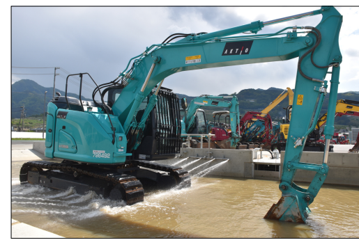
最新式の重機洗車プールと洗車ノズル
